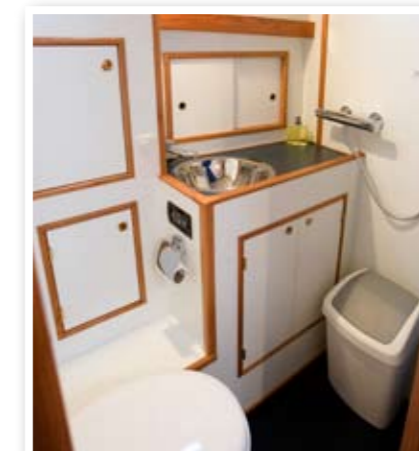
▲ MN 950: slim bedacht. Binnenzijde vlak is tevens douchevloer. Daardoor heb je bij twee meter binnenhoogte.
