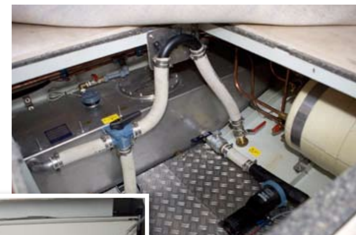
▲ De afdeling 'nattigheid' op de Bully 960 OK. Zoveel mogelijk gegroeped: watertanks, pompen en de boiler.
